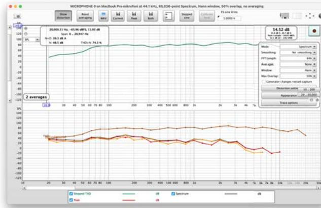
Kuva 18: Mesures avec l'analyseur temps réel (RTA) du logiciel REW
